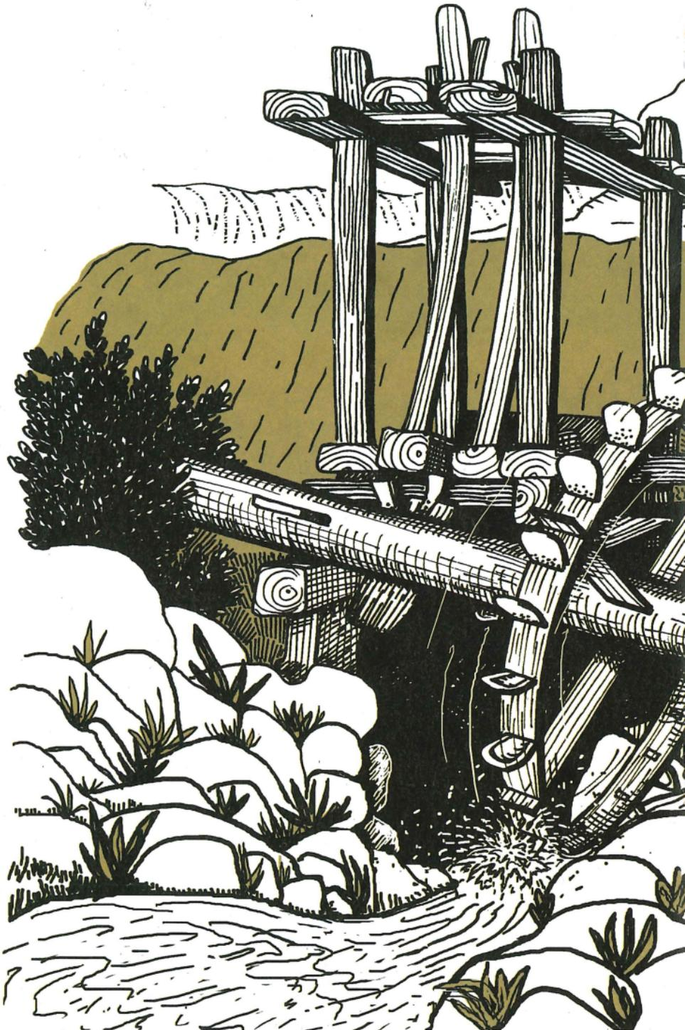
Erzählungen nach stand genau hier in dieser Kurve der Schlucht ein Gerät, welches dem Mittelalter eigen war: eine Walkmaschine (batán). Ein Holzrad, das durch Wasserkraft angetrieben wurde, setzte Holzhammer in Bewegung, die gegen die Stoffe schlugen. Dieses ständige Schlagen diente dazu, Stoffe in verschiedenen Stärken zu gewinnen.
