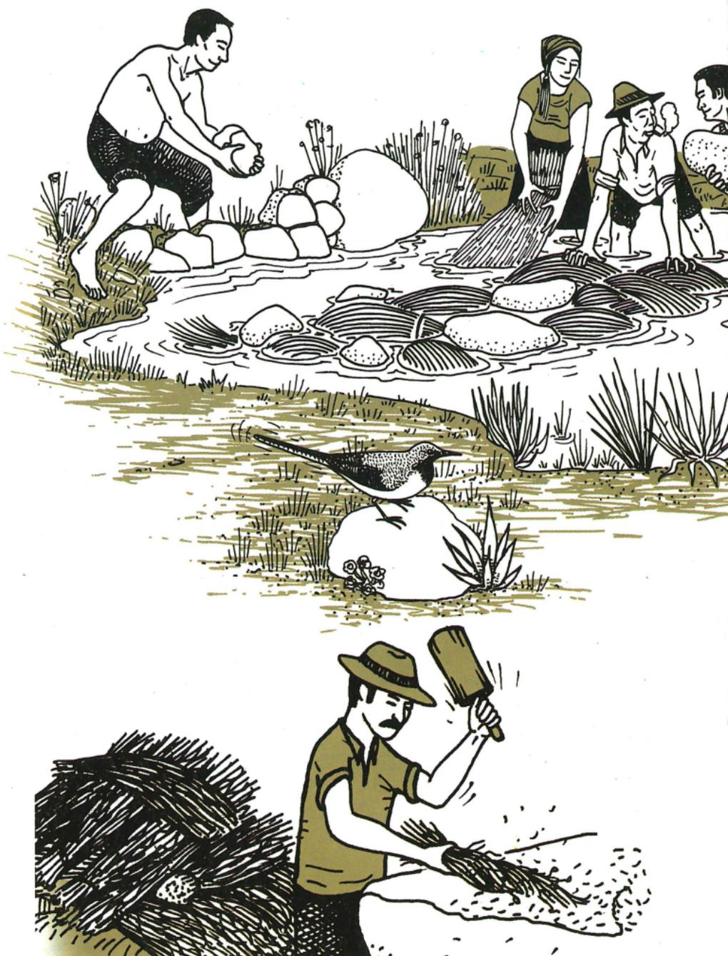
Gewährleistung einer qualitativ hochwertigen Textilproduktion abhing. Die Flachsfasern befinden sich innerhalb des Stieles der Pflanze. Um dessen Aussenseite aufzuweichen und die Gewinnung dieser Fasern zu erleichtern, wurde der Flachs etwa 8 Tage lang in Süßwasser gelegt. Sobald er trocken war, wurde er ausgeklopft, um den Stiel aufzubrechen, und "gekämmt", um die Faser sauber und bereit zum Bleichen und Spinnen zu machen.
